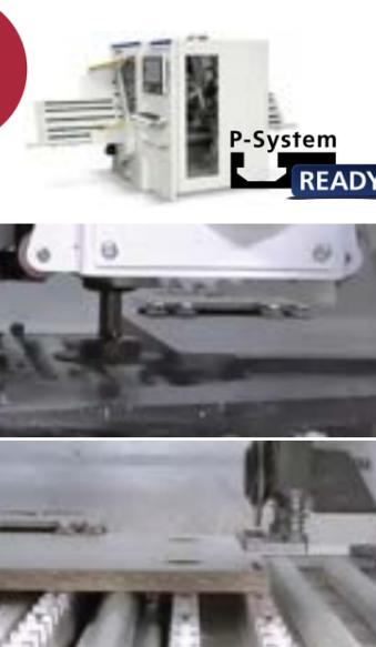
adattata, non si verificano danni durante la lavorazione di lastre verniciate e delicate. La macchina è disponibile con due diverse opzioni di testa di foratura F19L e F23L. Macchina compatta: L 425 cm, profondità 200 cm. Superficie di lavoro massima: 3050 x 950 x 60 mm, superficie di lavoro minima: 200 x 50 x 8 mm.
